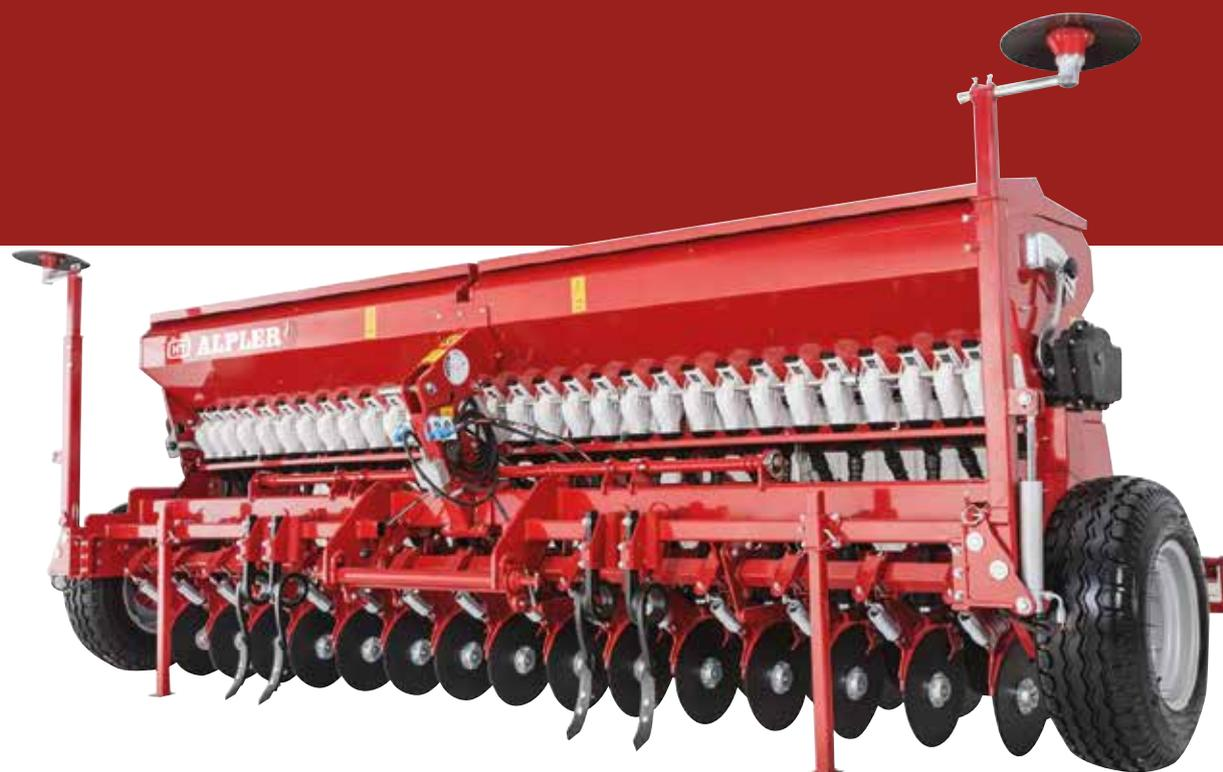
Зерновые сеялки Demetra используются для посева всех видов зерновых и мелкосемянных культур, обеспечивая качественный и равномерный посев по классической технологии почвообработки.
