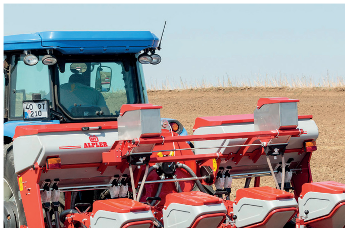
Распределитель микро-гранулированных удобрений и химических порошков
